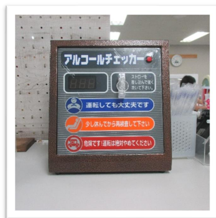
センターに設置しているアルコール検知器
